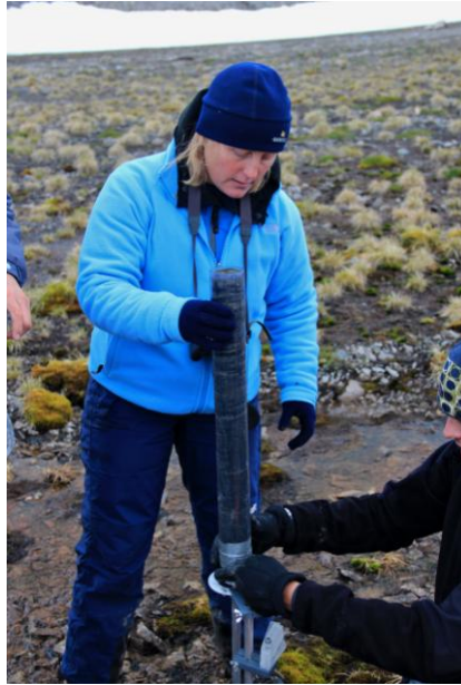
Obr. 4.8.1: Odběr sedimentu ze dna jezera (kóru) pro paleolimnologické účely (Jan Kavan, 2012)
