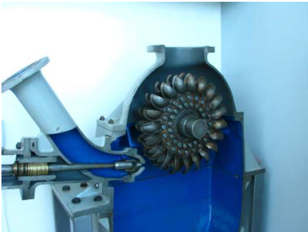
Obrázek 16 Řez Peltonovo turbínou [ 2 ]
