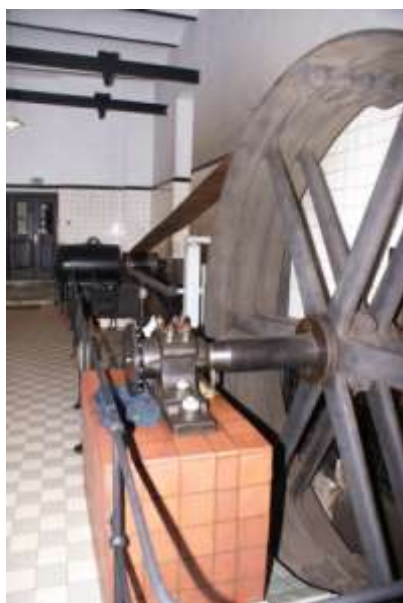
Obrázek 21 Převod koženým řemenem
