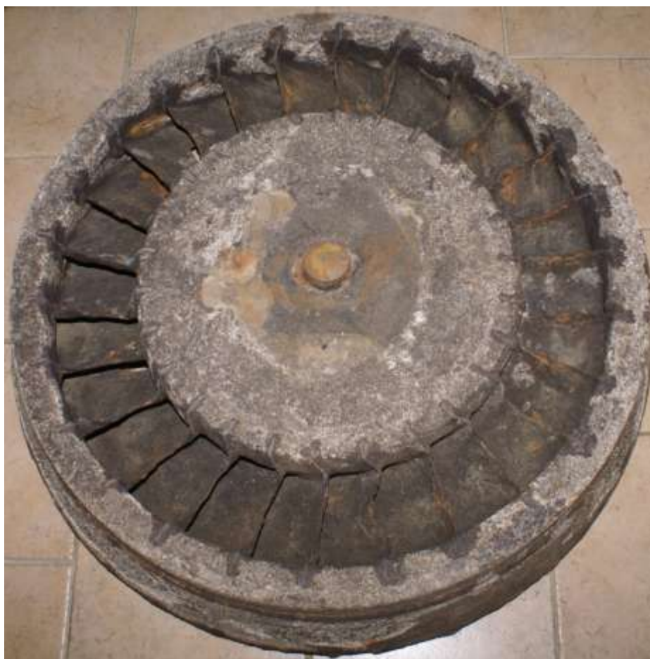
Obrázek 10 Betonové oběžné kolo
