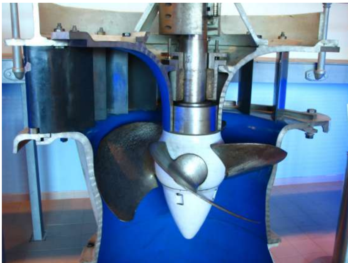
Obrázek 17 Řez Kaplanovou turbínou [ 3 ]
