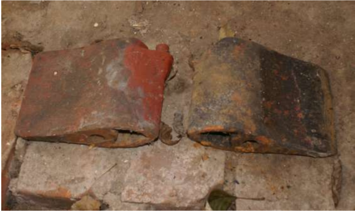
Obrázek 14 Rozváděcí lopatky Francisovy turbíny elektrárny v Lékařově Lhotě
