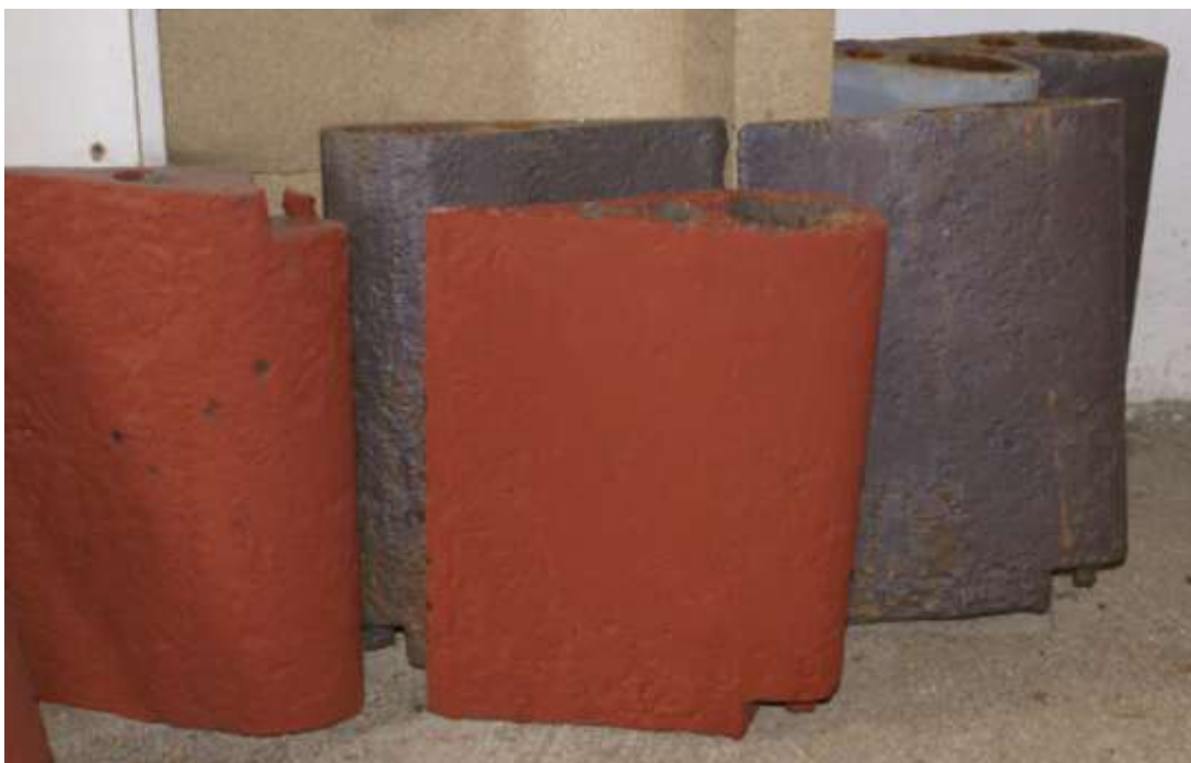
Obrázek 3 Opravené rozváděcí lopatky
