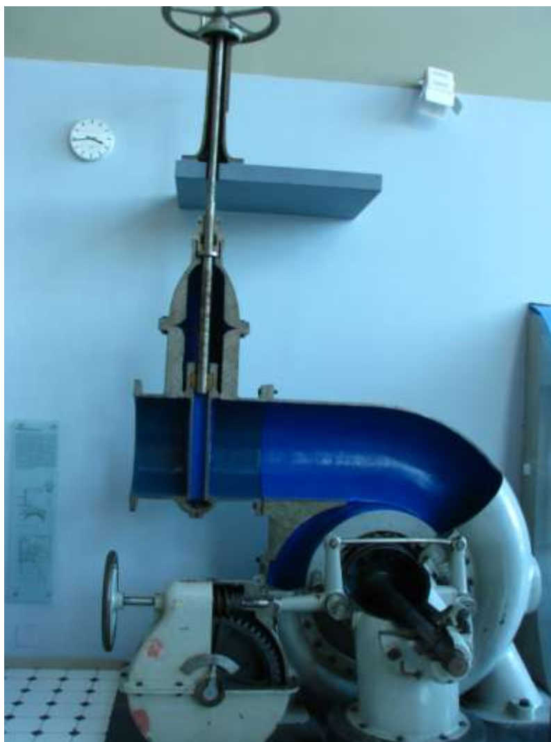
Obrázek 15 Řez Francisovo horizontální spirální turbínou [ 1 ]
