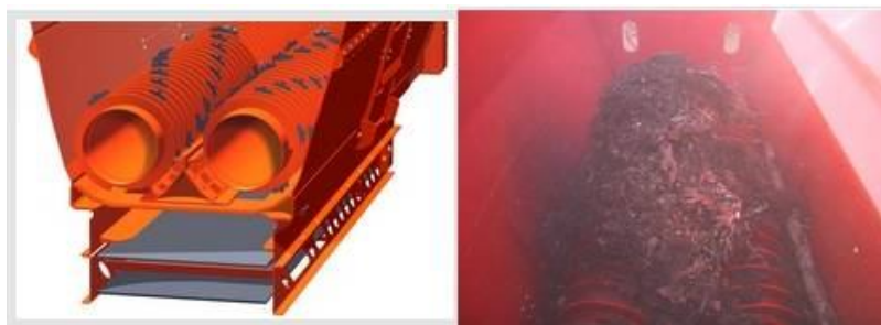
Obr. 6 Mechanismus nízkootáčkového drtiče (2)
