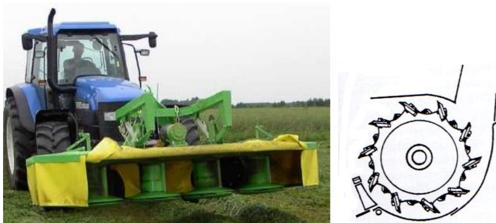
Obr. 2 Mobilní čtyřbubnová sekačka a sekací ústrojí bubnové sekačky (20, 10)
