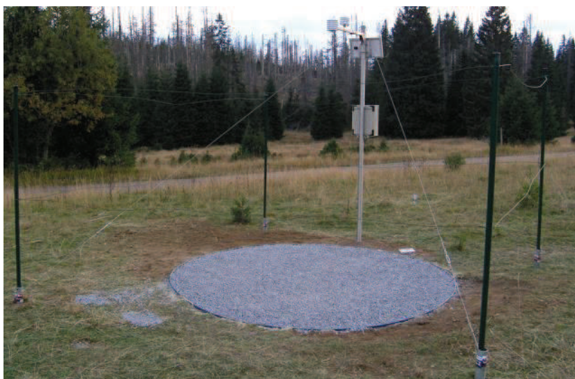
Obrázek 3: Sněhoměrný polštář (CHMI)
