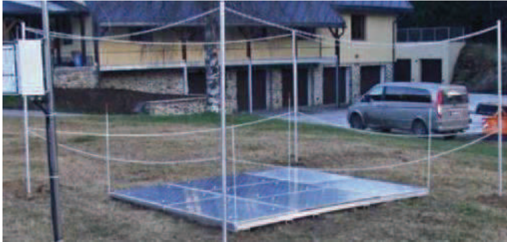
Obrázek 5: Váhový sněhoměr (Jeníček 2013)
