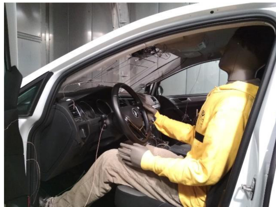
Obrázek 4.5 – Manekýn Newton posazen v autě [77]
