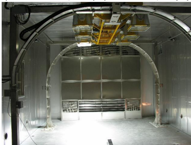
Obrázek 4.10 - Klimatická komora VUT [39]
