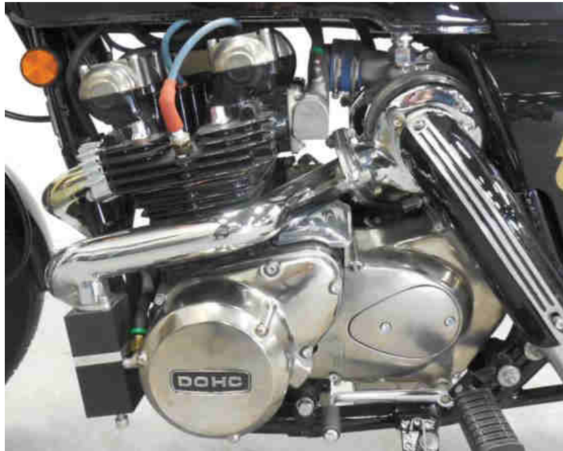
Obr. 16: Umístění turbodmychadla na Kawasaki Z1R-TC [6]
