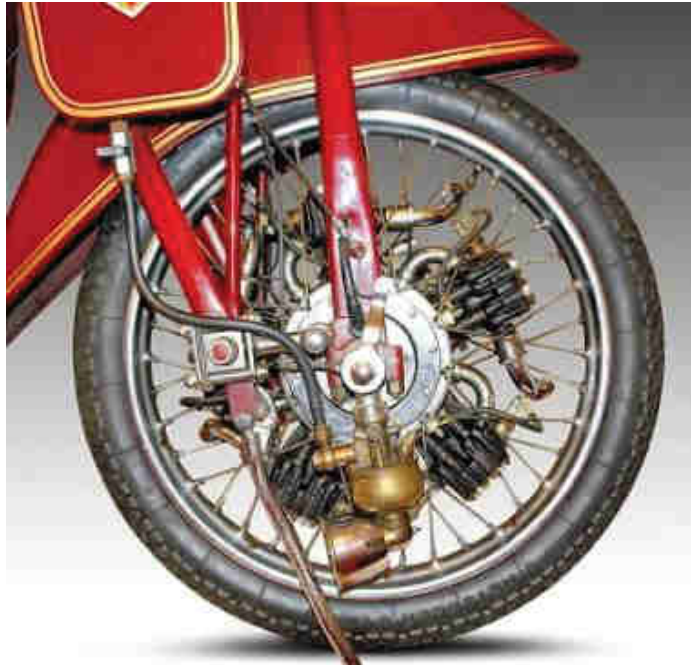
Obr. 18: Motor motocyklu Megola [25]
