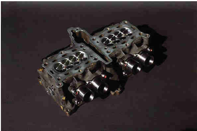
Obr. 11: Hlava Válců Honda NR500 (pohled zespodu) [11]
