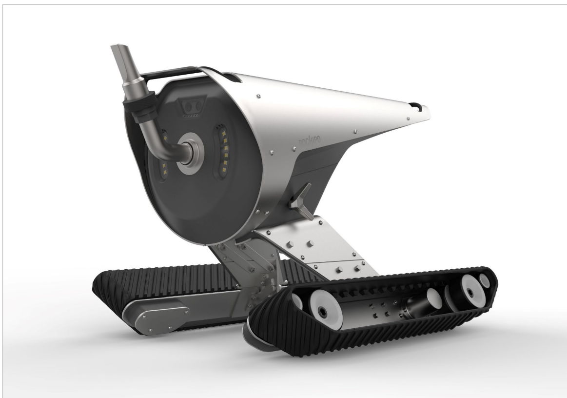
Obr. 6-11 Natočené pásy pro kruhová potrubí.
