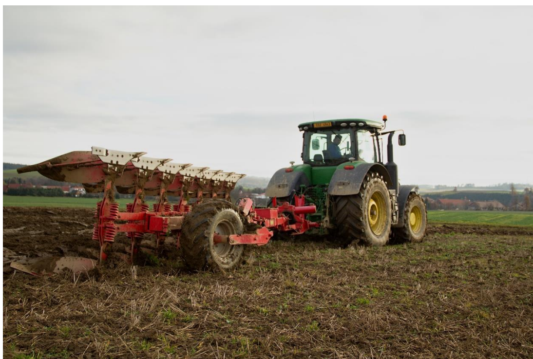
Obrázek 1.2: Orba oboustranným poloneseným pluhem
