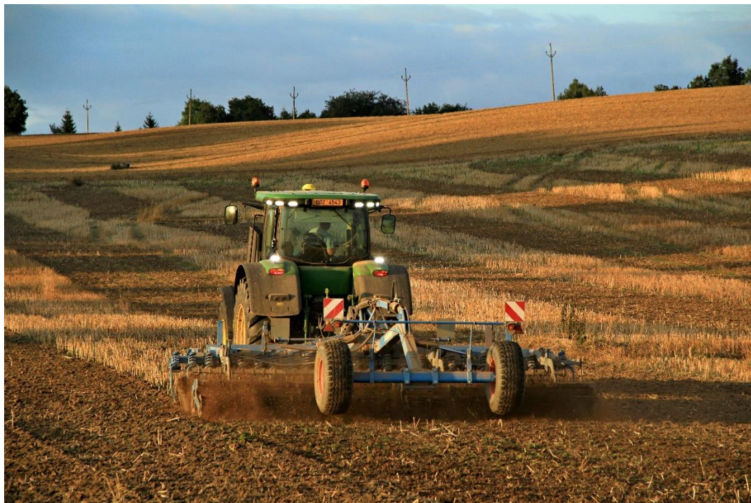
Obrázek 1.1: Podmítka řepkového strniště talířovým podmítačem Lemken Rubin 9
