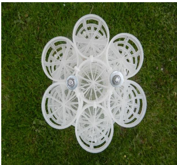
Obr. 34: Sestavený a zpevněný umělý substrát foto Bc. J. Gracík, 10. 3. 2016
