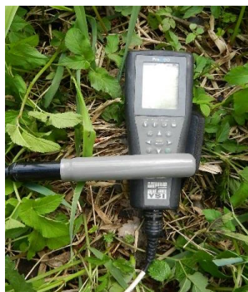
Obr. 42: Mutimetr YSI ProODO
