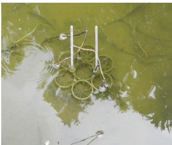
Obr. 36: Ponořený vzorkovač (odtok z rybníka Gebhartsteich) foto Bc. J. Gracík, 9. 6. 2016
