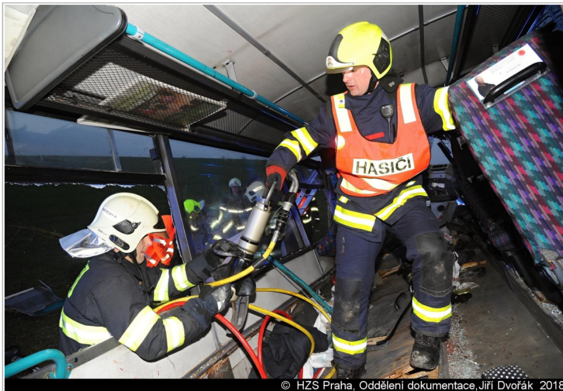
Obrázek 8: Vyprošťování osob z autobusu pomocí hydraulického zařízení
