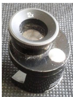
Obr. 13: Brinellova lupa. Zdroj: [vlastní]
