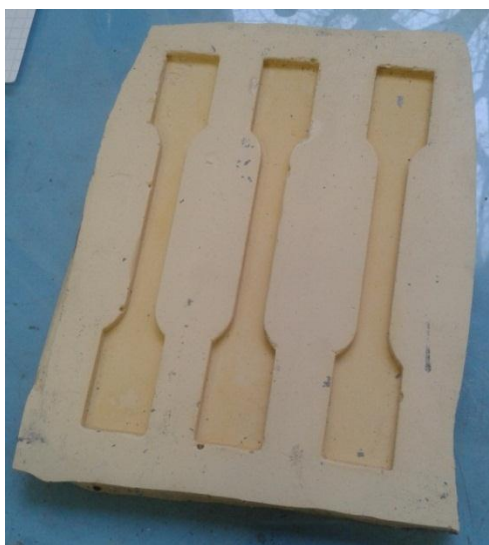
Obr. 7: Forma pro odlévání univerzálních plochých zkušebních těles. Zdroj: [vlastní]
