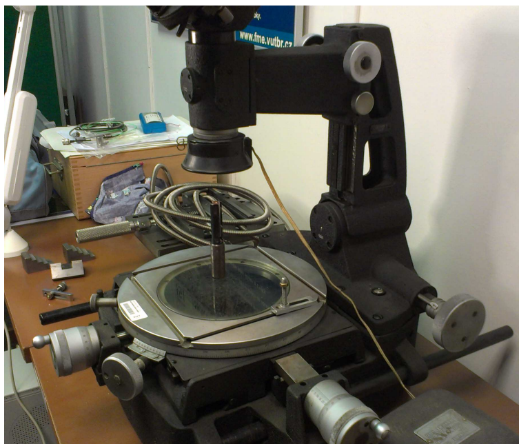
Obr. 70 Měření geometrie břitu řezného nástroje
