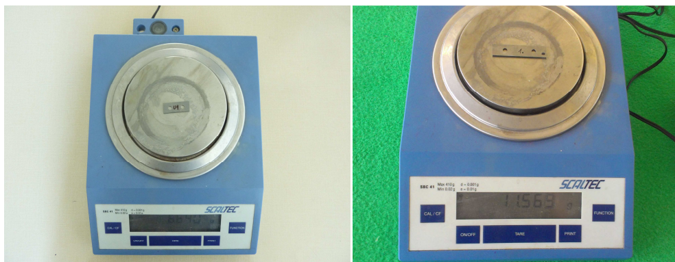
Obr. 34 Měření opotřebení břitu na základě hmotnosti břitu
