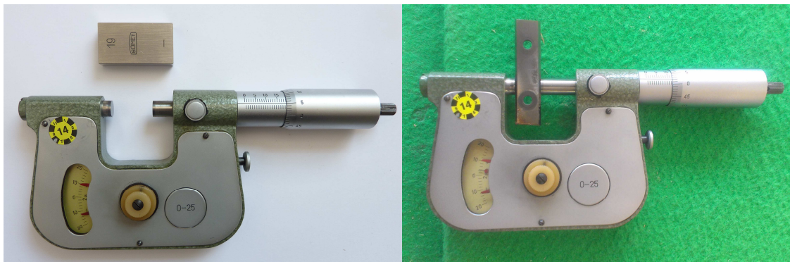
Obr. 33 Přístroj Passometr Somet, vlevo: se vzorovou měrkou, vpravo s měřeným břitem
