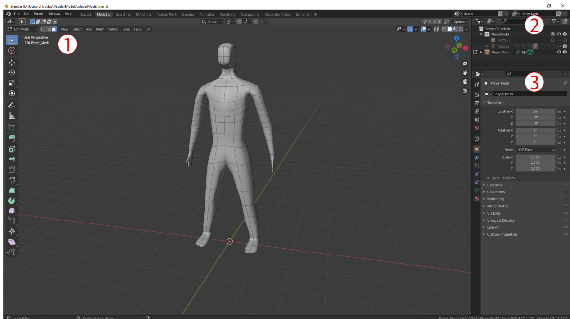
Obrázek 2.6: UI pre tvorbu 3D modelov v Blenderi. 1. 3D Viewport zobrazujúci model na ktorom sa pracuje 2. Outliner zobrazuje hierarchiu objektov 3. Properties dovoľuje modifikovať a pridávať vlastnosti do sceny a jej objektov.
