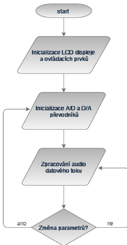
Obrázek 2.10 Princip činnosti obslužného programu procesoru STM32F446RET
