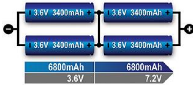
Obr. 14 Sériově paralelní zapojení čtyř článků (2s2p) [47]
