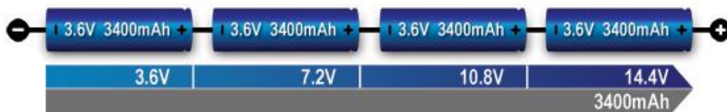
Obr. 12 Sériové zapojení čtyř článků (4S) [47]
