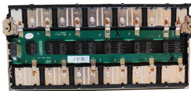
Obr. 25 Bateriový module BYD 12S1P [71]
