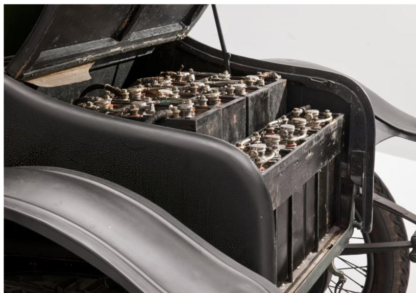
Obr. 3. Edisonova baterie s 54 nikl-železnými články, elektrovozidlo Detroit Electric Model 47 [15]
