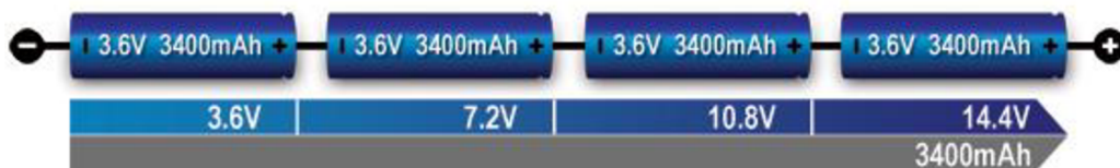
Obr. 12 Sériové zapojení čtyř článků (4S) [47]
