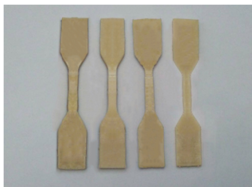
Obrázek 3.35: Vybraná zkušební tělesa pro tahovou zkoušku (typ MAPZCZ).
