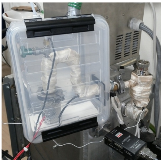
Obrázek 3.12: Výparník kapalných prekurzorů instalovaný k nízkotlaké mikrovlnné plazmové aparatuře.
