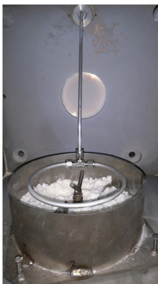
Obrázek 3.20: Míchací zařízení se zařízením gas ring uzpůsobené pro ošetření práškové celulózy.
