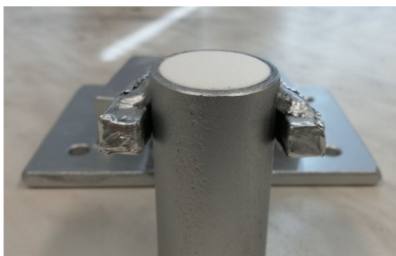
Obrázek 3.19: Celulóza stlačená do formy tablety v přípravku tabletovacího zařízení.
