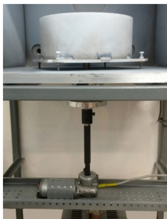
Obrázek 3.14: Míchací zařízení instalované do nízkotlaké aparatury.
