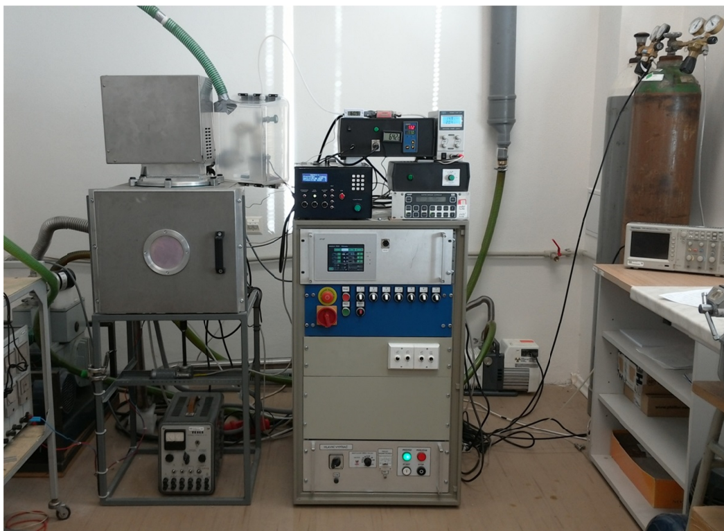
Obrázek 3.6: Nízkotlaká mikrovlnná plazmová aparatura.
