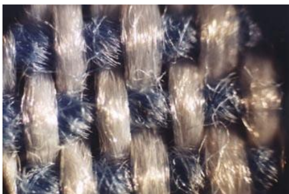
Obrázek 9 - Tkanina z polyesteru a bavlny před působením vyšší teploty, bílá - PES, modrá – bavlna [58]
