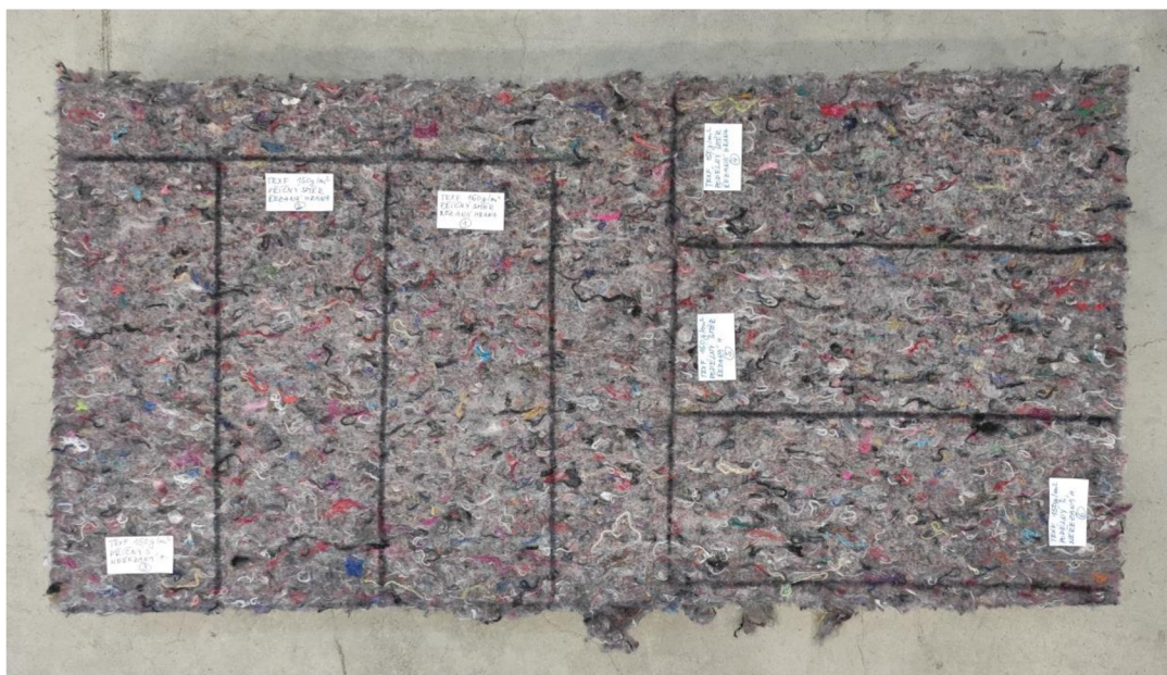
Obrázek 23 - Vyznačení rozměrů vzorků na ošetřené izolaci
