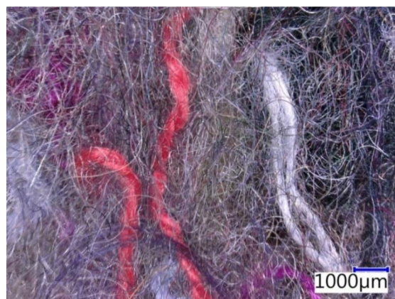
Obrázek 16 - Trhanina pod mikroskopem, zvětšeno 30 x
