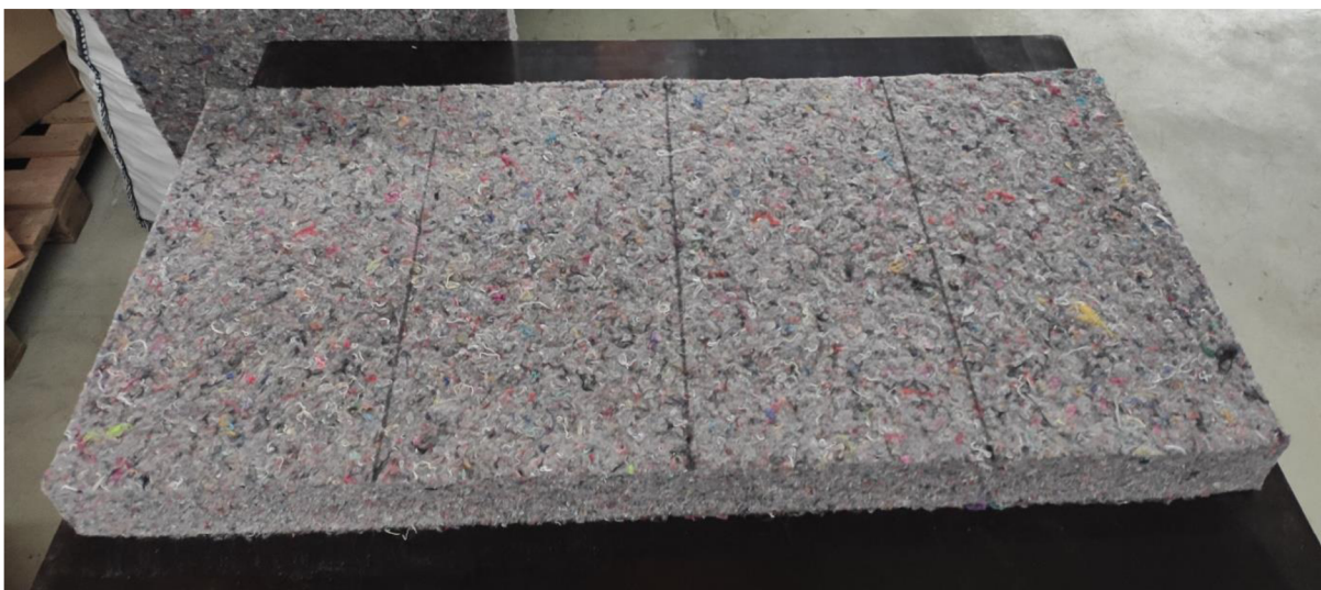
Obrázek 18 - Izolační rohož, 80 % recyklovaná textilní vlákna, 20 % bikomponentní vlákna, zhotovená metodou Air-lay ve firmě Retex a.s.
