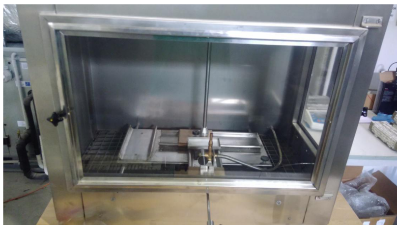
Obrázek 25 - Zkušební komora pro zkoušku malým zdrojem plamene
