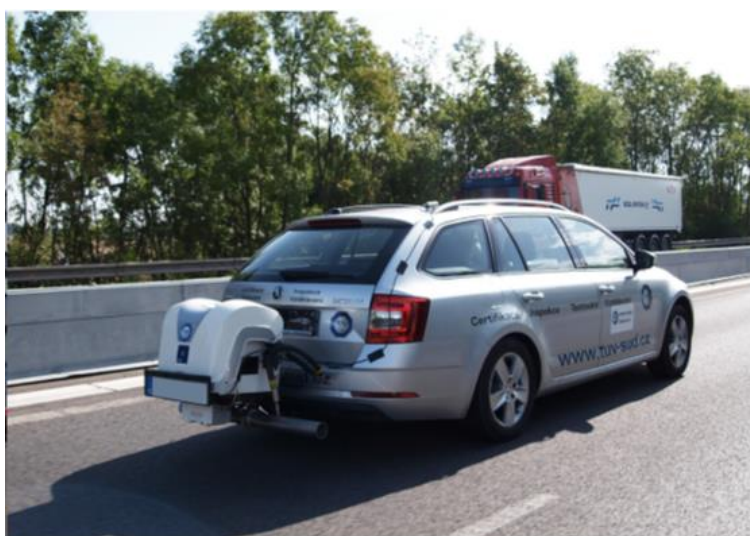
Obrázek 26: Vozidlo při zkoušce RDE s namontovaným měřicím modulem PEMS [37]
