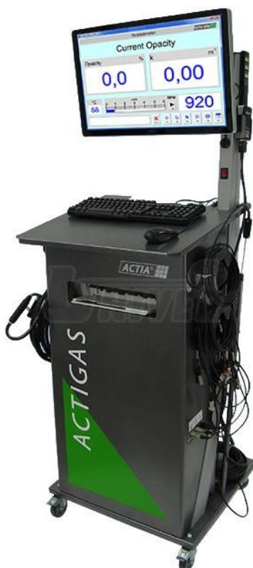
Obrázek 20: Mobilní stojan vybavený ACTIBOX PC stanice ACTIGAS 605 [25]
