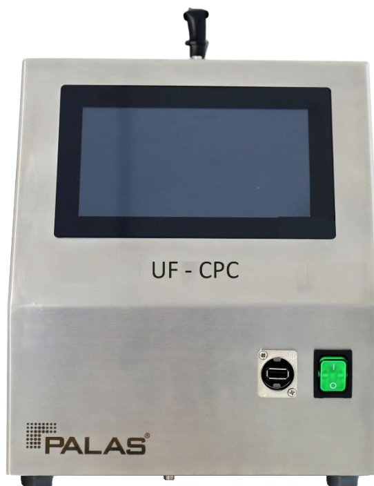
Obrázek 30: Kondenzační čítač částic Palas UF-CPC 200 [44]
