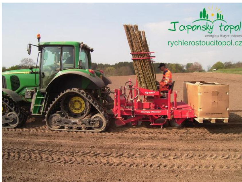
Obrázek č. 3 – Mechanizovaná výsadba celých prýtů (rychlerostoucitol.cz)
