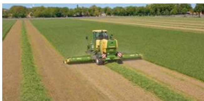
Obrázek č. 10: Samojízdný žací mačkač Krone Big M s aktivní funkcí usměřování posečené píce.
