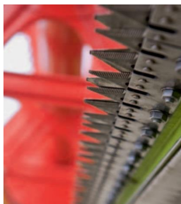
Obrázek č. 4: Dvojitá kosa na obilním adaptéru Claas Vario. Zdroj: (CLAAS, 2015).
