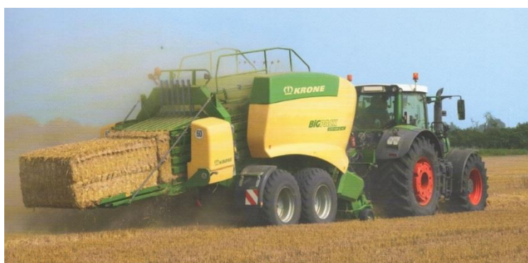
Obrázek č. 23: Lis Krone Big Pack 1290 HDP II na velké hranolovité balíky. Zdroj: (KRONE, 2015).
