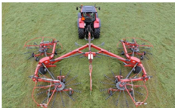
Obrázek č. 16: Rotorový obraceč Lely Hibiscus se čtyřmi velkými rotory.
