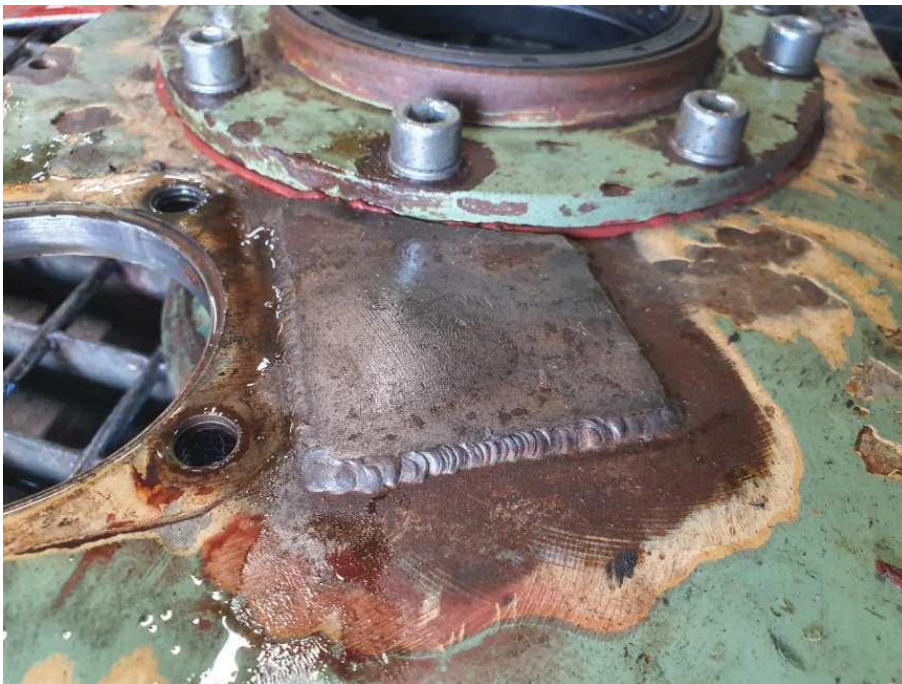
Obr. 1.21 Oprava poškození způsobeném zadřením ložiska
