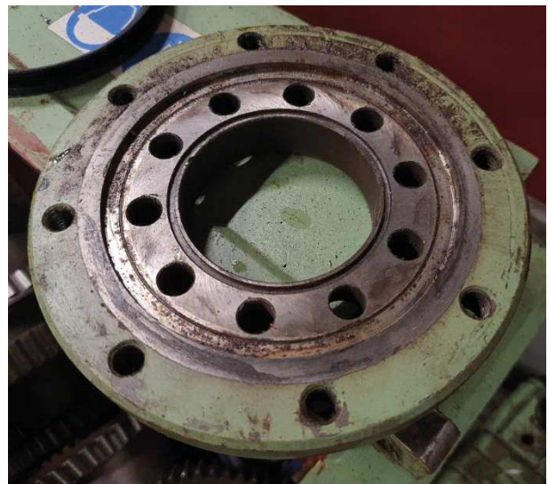
Obr. 3.36 Unášecí příruba pro současnou vrtnou hlavu
