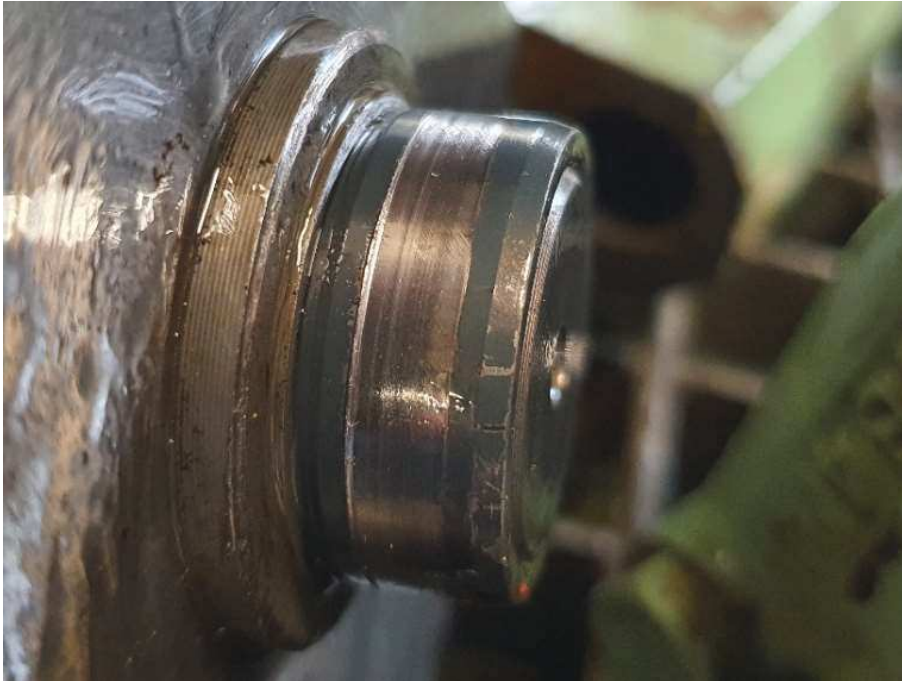
Obr. 1.20 Spodní uložení sekundární hřídele – vnitřní ložiskový kroužek
