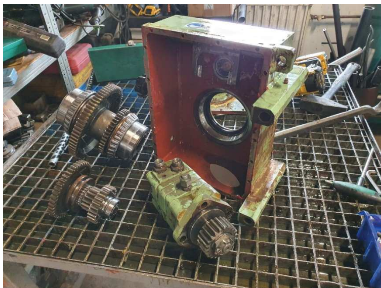
Obr. 1.12 Demontáž stávající vrtné hlavy
