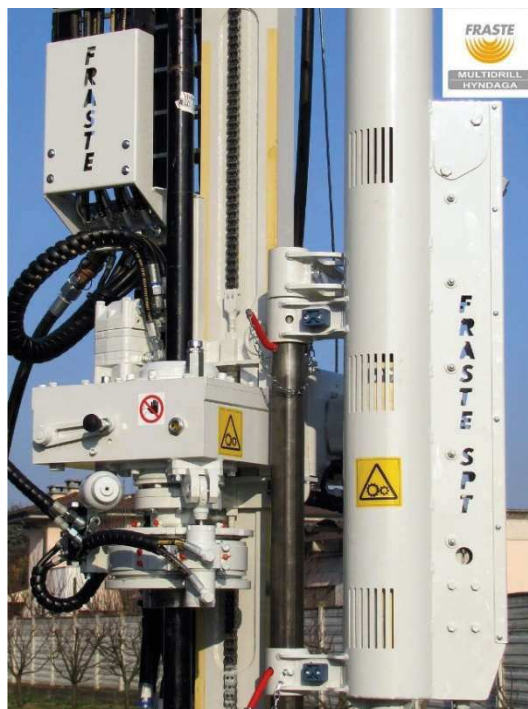
Obr. 1.22 Vrtná hlava fotografie výrobce [3]
