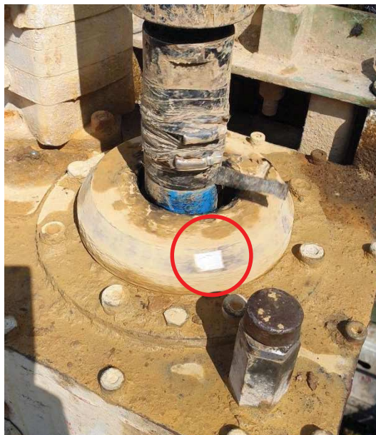
Obr. 1.15 Značka pro měření otáček původní vrtné hlavy
