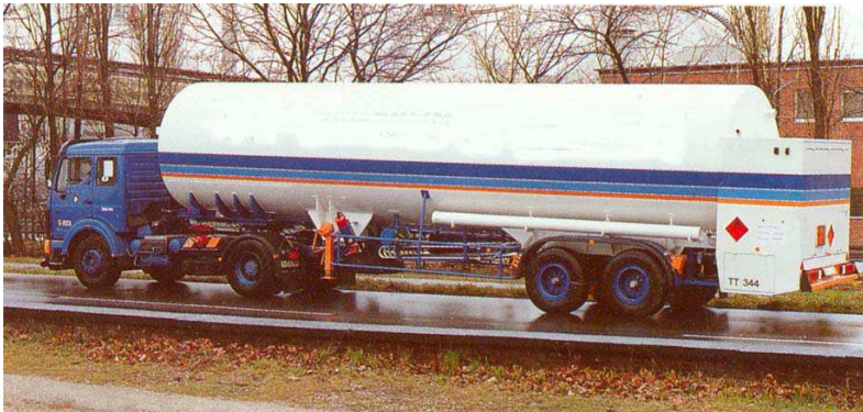
Obr.22 Autocisterna s kapalným vodíkem o kapacitě 30 000 litrů
