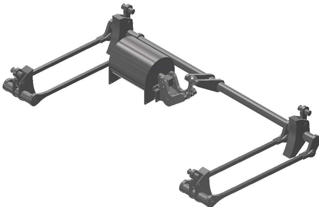
Obr. 36 Mechanismus špalíkové brzdy
