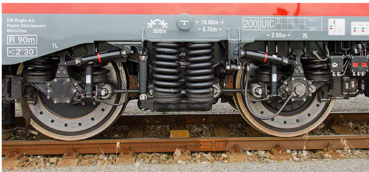
Obr. 29 Řešení příčného vypružení pružinami flexicoil na lokomotivě Škoda 109E [8]
