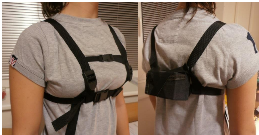
Obrázek 5.7 – Připevnění akvizičního systému na měřené osobě
