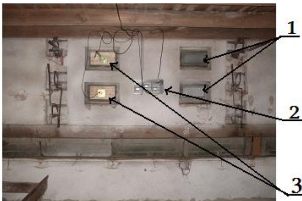
Obr. 8 Pohled na stěnu sušící komory: 1 – přístupové otvory, 2 – snímače teploty a relativní vlhkosti vzduchu, 3 – měřící sondy.
