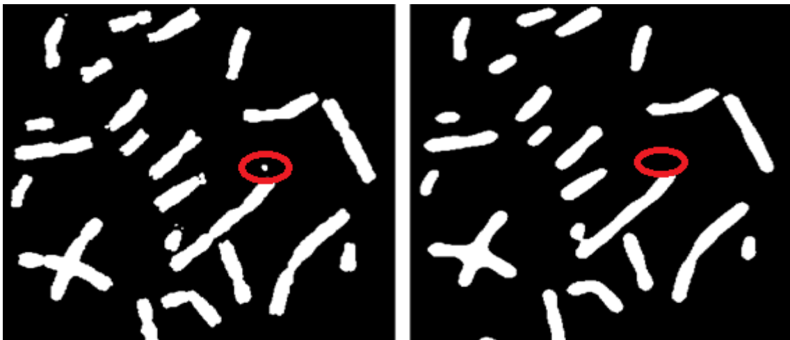
Obrázek 23: Binární obraz po naprahování Otsu metodou (vlevo) a binární obraz po naprahování a následné mediánové filtraci (vpravo)
