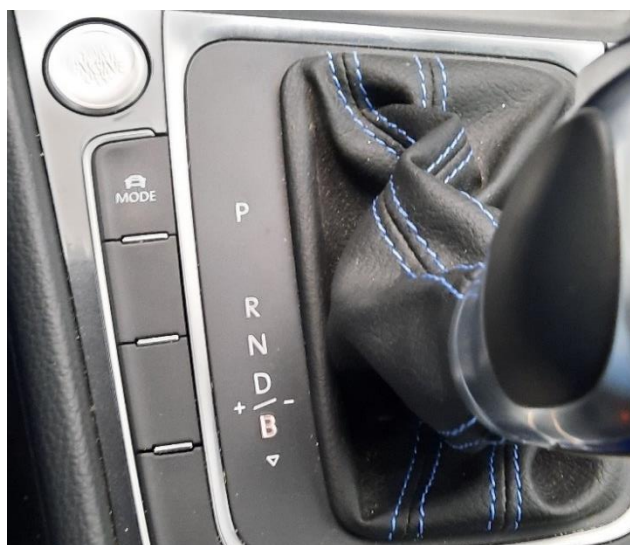
Obrázek 23 Volič automatické převodovky s možností volby rekuperačního brzdění „B“
