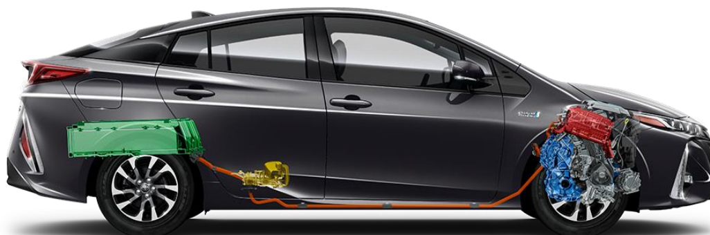
Obrázek 5 Full hybridní soustava Toyota Prius 2020
