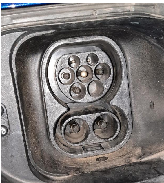
Obrázek 25 Konektor Mennekes Typ 2 respektive konektor CCS combo v e-Golfu
