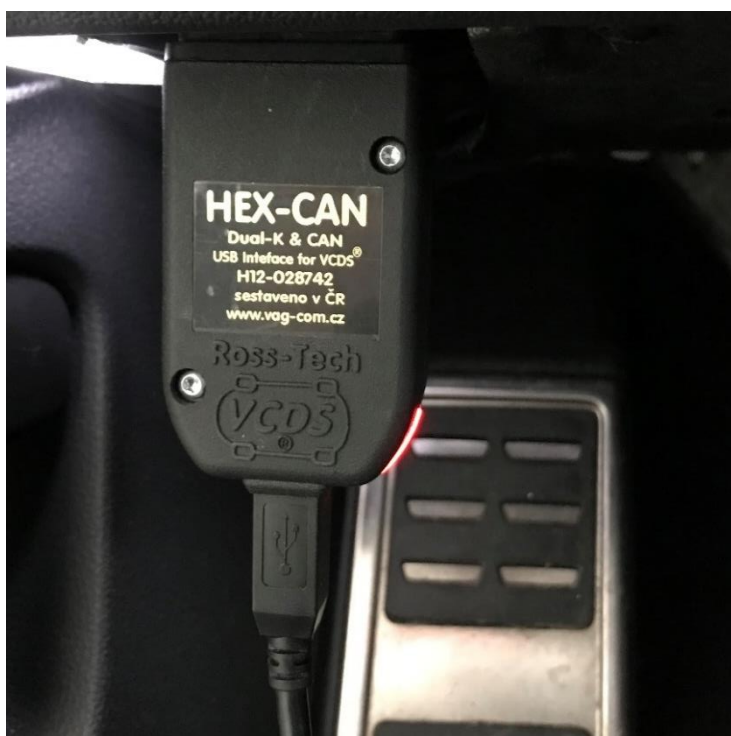
Obrázek 30 Připojené zařízení HEX-CAN v testovaném Golfu GTE
