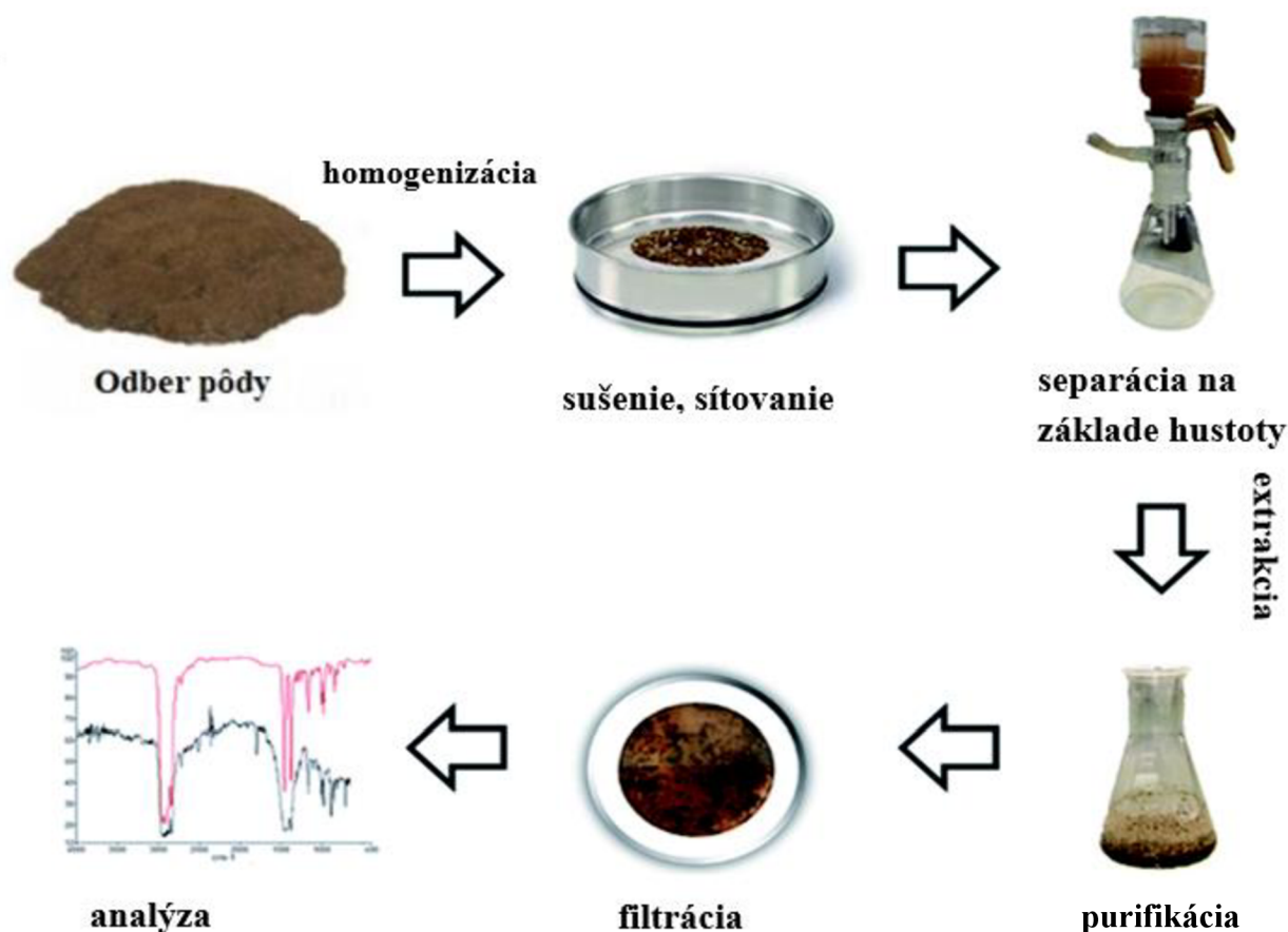
Obr. 4: Postupné kroky vedúce k identifikácii mikroplastov v pôde [65].
