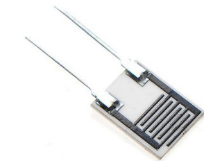
Obr. 3 - Odporový snímač vlhkosti pracující na hygrometrickém principu [5]
