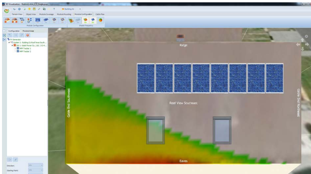
Obr. 8.22: PVSol – On-grid – Rozložení panelů na střeše
