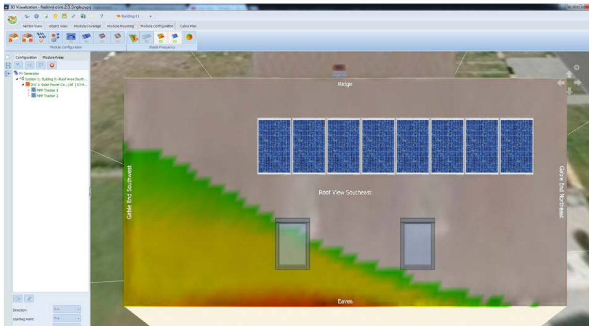
Obr. 8.22: PVSol – On-grid – Rozložení panelů na střeše
