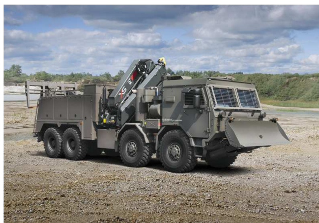
Obr. 19 T 815 jako armádní těžké vyprošťovací vozidlo, [17]
