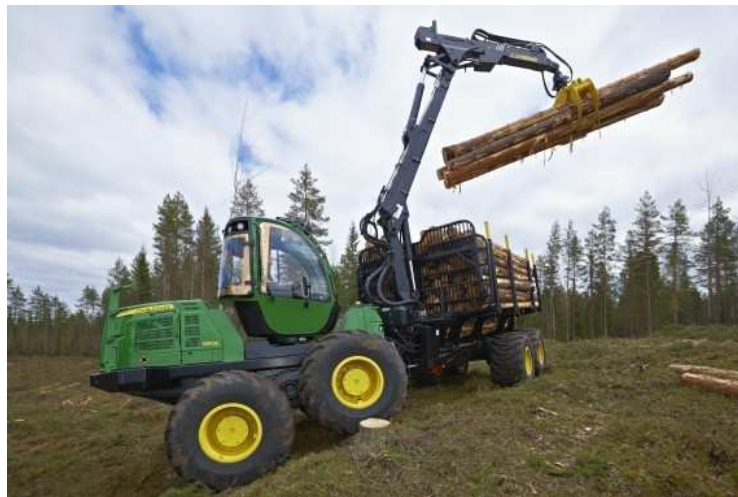
Obr. 16 Vyvážecí traktor při nakládce kmenů, [14]
