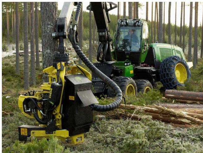
Obr. 15 Harvester při kácení stromu, [13]
