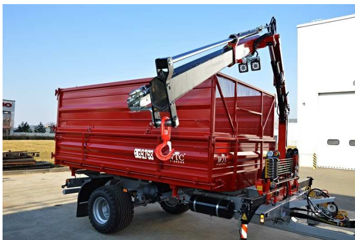
Obr. 13 Hydraulická ruka na taženém dopravním prostředku, [11]
