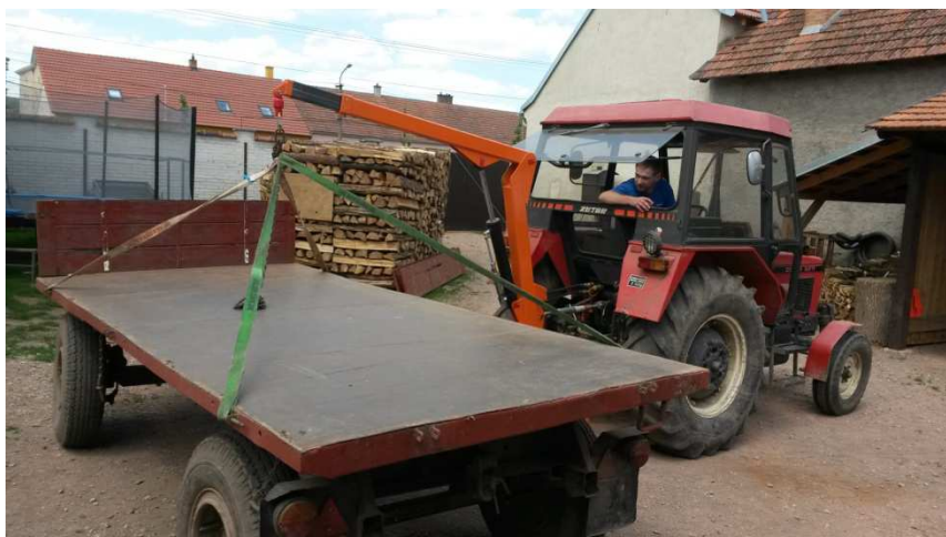
Obr. 21 Ruka domácí výroby při demontáži ložné plochy přívěsu, [19]
