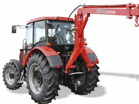
Obr. 12 Hydraulická ruka do tříbodového závěsu traktoru, [10]
