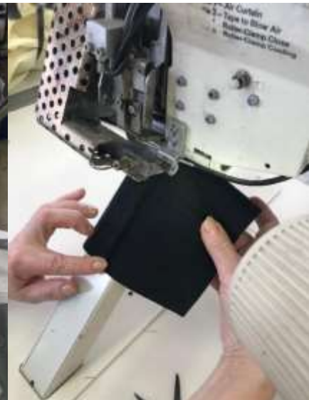
Obrázek 13 Ukázka podlepení vzorku
