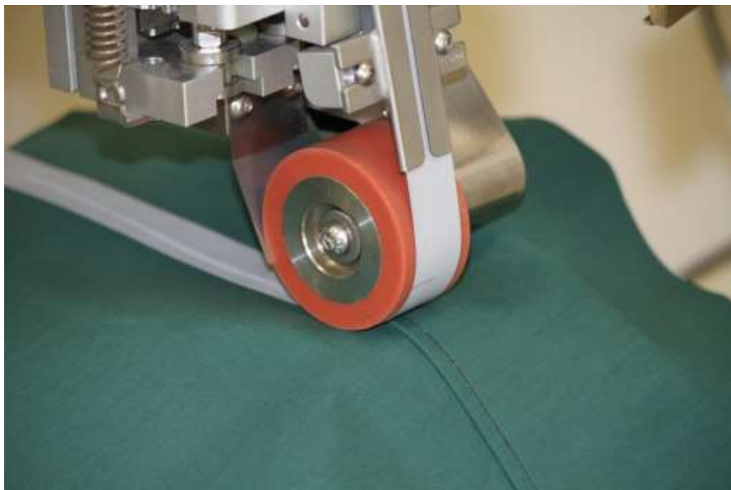
Obrázek 10: Podlepení páskou u firmy FRAMIS ITALIA [51]
