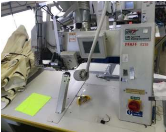
Obrázek 14 Svařovací stroj PFAFF 8330
