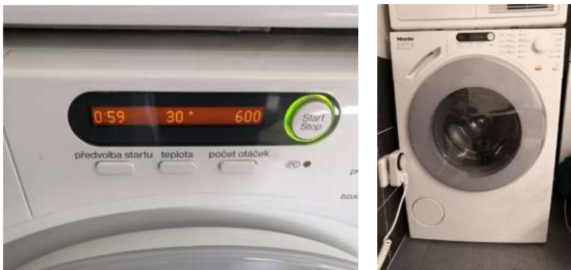
Obrázek 16 Nastavené parametry pro zkoušku praní a automatická pračka MIELE FOTRONIC W 1734
