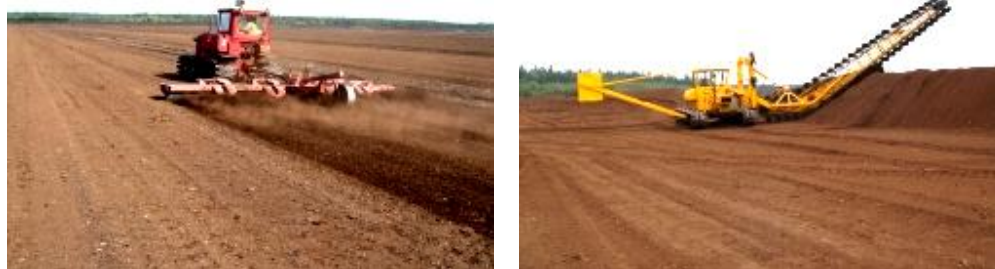
Obrázek č. 19 a č. 20: Těžba rašeliny – frézování a úprava valů, zdroj: http://www.raselina.cz/cinnost-firmy/tezba , dostupný dne 13. 4. 2013.
