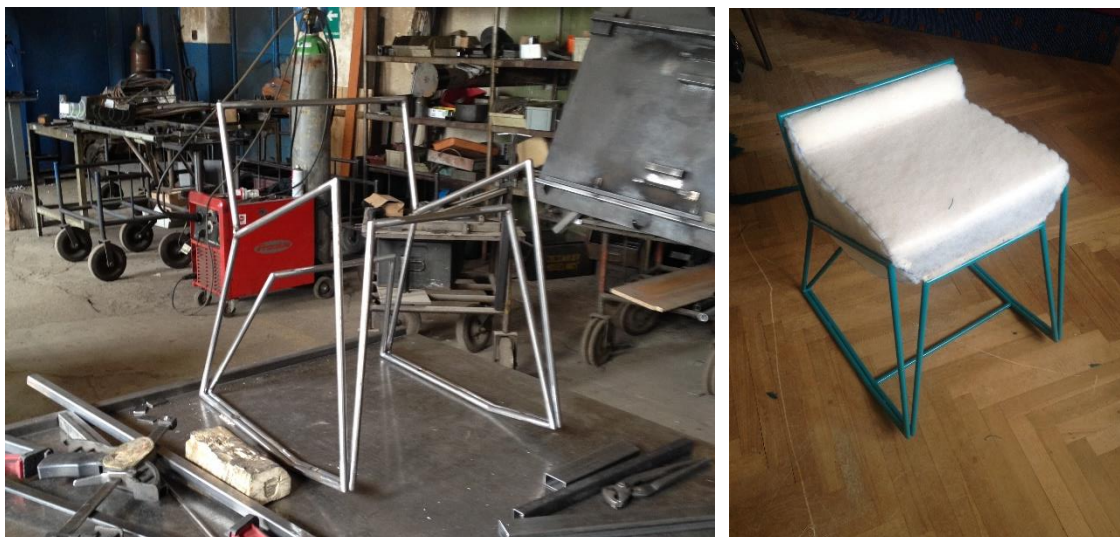
Obr. 76 Výroba podnože a sedákové části
