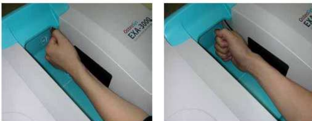
Obrázek 4. Měření denzity předloktí pomocí přístroje EXA-3000
