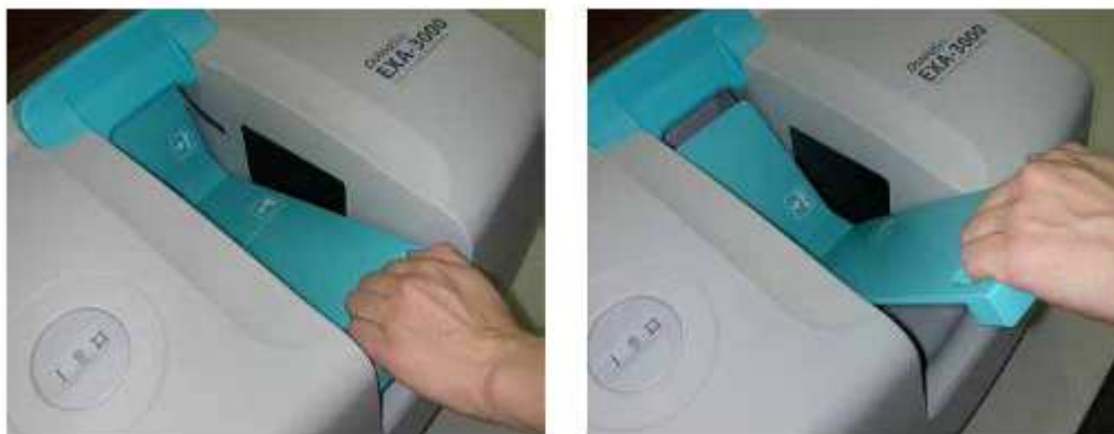
Obrázek 5. Změna polohy přístroje EXA-3000 z měření předloktí na měření paty
