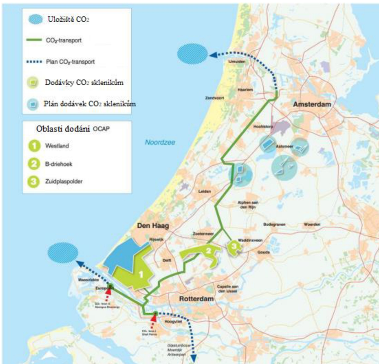
Obr. 30 Mapa Nizozemí s vyobrazenou stávající potrubní sítí pro dodávky CO 2 společně s rozšířením o několik míst dodávek a uložení [52]
