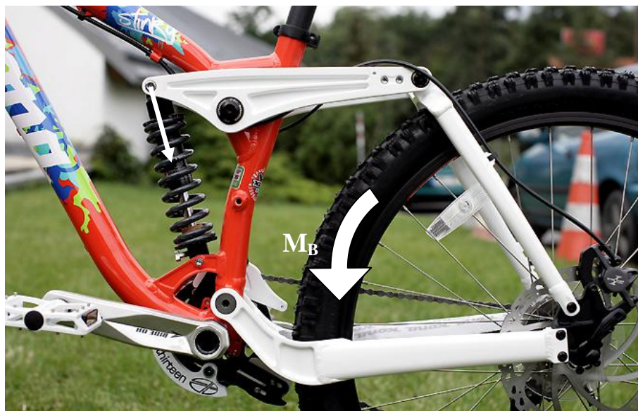
Obrázek 4.1: Rám Kona Stinky 2009, kompresivní působení brzdných účinků, šipka znázorňuje směr pohybu vahadla při brždění vlivem momentu M_B [8]
