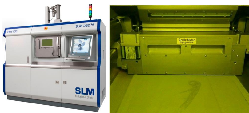
Obrázek 10.1: SLM 280 HL [33] a pracovní prostor v počáteční fázi tisku vahadla
