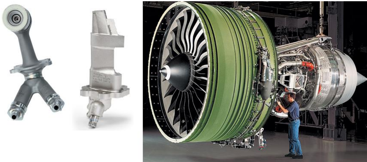
Obrázek 10.2: Palivová tryska, uložení tlakového senzoru a proudový motor GE9X [36] [38]
