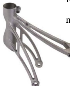
Obrázek 11.17: Postup při optimalizaci topologie, sedlová trubka rámu Empire Cycles, vyrobená 3D tiskem ze slitiny Ti [39]
