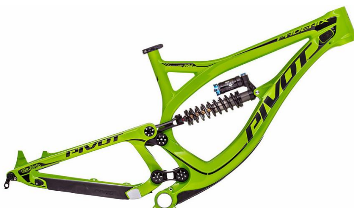
Obrázek 4.9: Rám Pivot Phoenix Carbon určený pro sjezd, se systémem zavěšení DW-Link [21]
