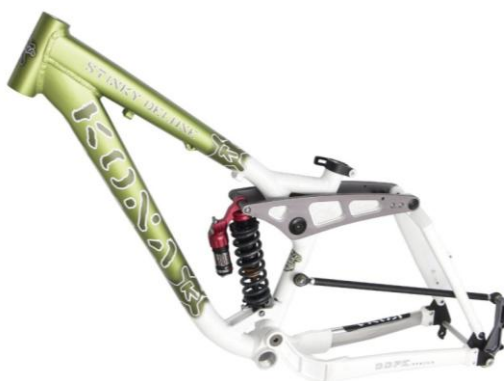
Obrázek 4.6: Rám Kona Stinky a D.O.P.E. systém plovoucího třmenu zadní brzdy [15]
