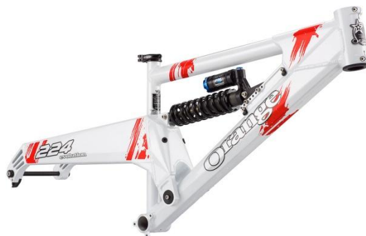
Obrázek 4.5: Rám Orange 224-DH určený pro downhill, jednočep [13]
