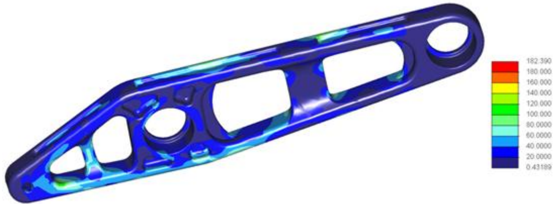
Obrázek 11.1: Návrh odlehčení a průběhy napětí Von Mises s maximální hodnotou 182 MPa
