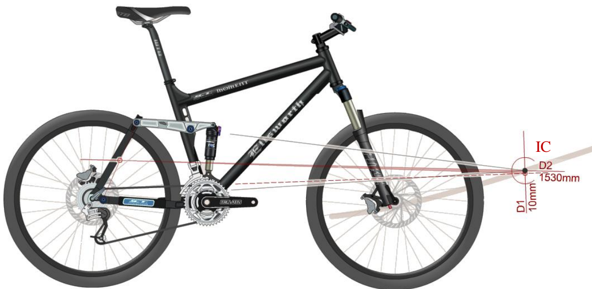
Obrázek 4.7: Ellsworth ICT, zobrazení IC s polohou nad tažnou větví řetězu [18]
