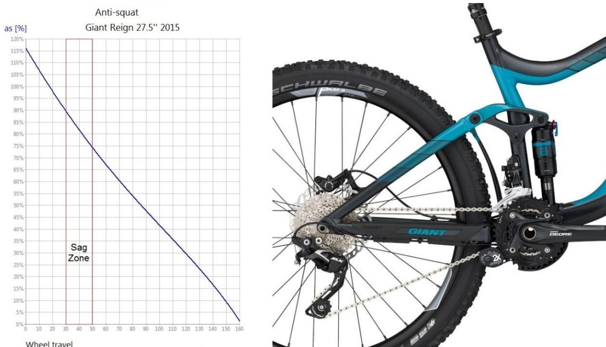
Obrázek 4.4: Závislost anti-squatu na zdvihu pístnice tlumiče se znázorněnou sag oblastí, jedná se o rám Giant Reign s 27.5" koly [12]
