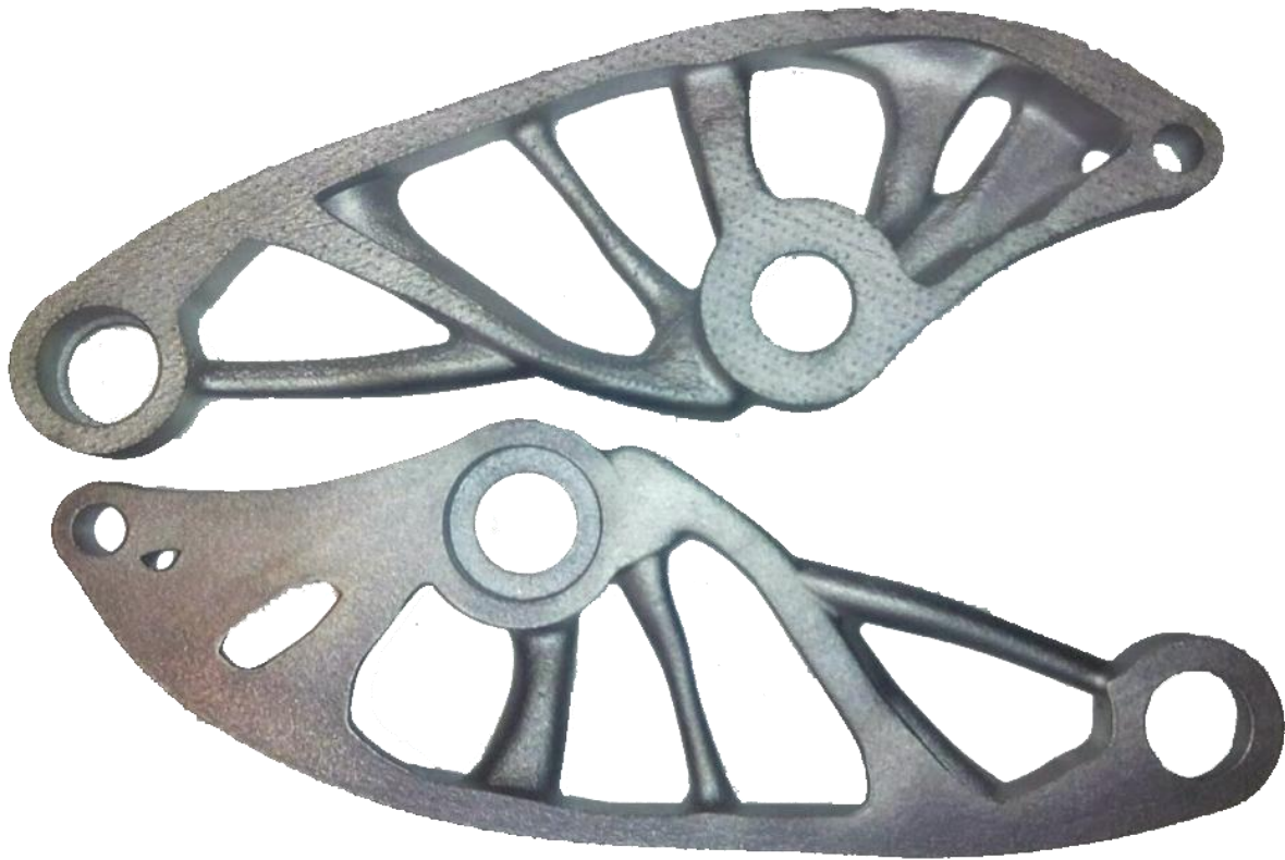
Obrázek 11.27: Vyrobená horní vahadla, spodní vahadlo po ručním opracování, vrchní pouze po pískování
