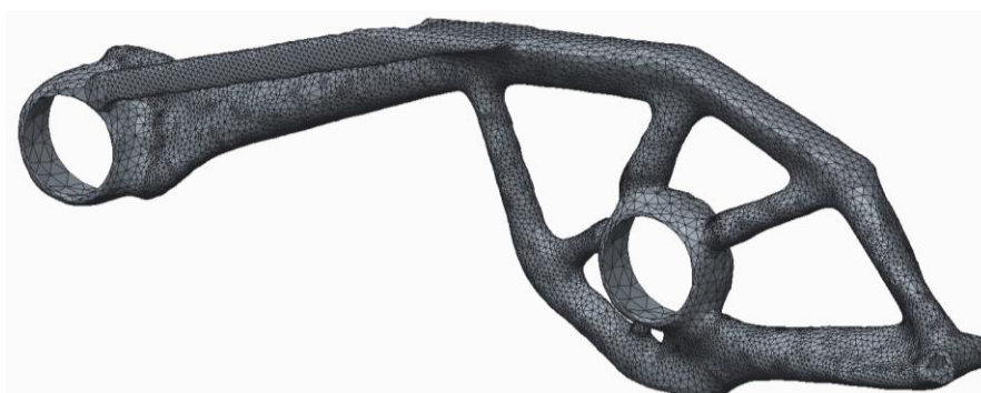
Obrázek 11.18: Síť MKP optimalizovaného dílu, m=0.104\text{kg} , díl je bez přídavků na obrábění a opěrných stěn ložisek, kvůli menšímu počtu prvků, pro urychlení výpočtu
