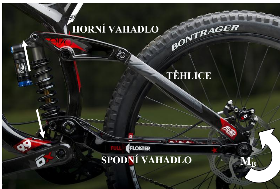
Obrázek 4.2: Trek Session 9.9 s typem zavěšení ABP, znázornění extenzivního působení brzdných účinků, šipky znázorňují směry pohybu vahadel při brždění vlivem momentu M_B [9]
