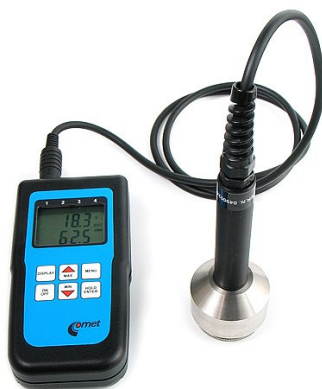
Obr.5 –Přístroj na měření teploty a vlhkosti vzduchu ( Commeter D 3121 E )
