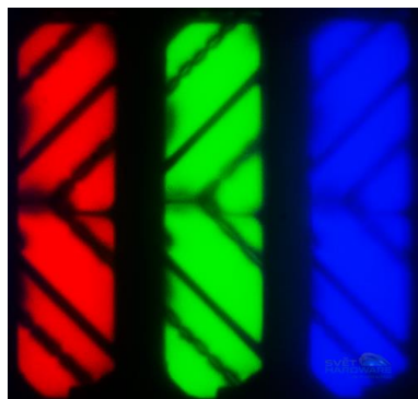
Obr. 14 Mikroskopický pohled na subpixely S-PVA technologie
