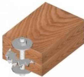
Obr. 3 Použití hmoždíku typu Bulldog
