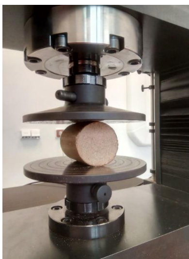
Obrázek 7 Ilustrační uchycení zkoušené brikety ve stroji LabTest 5.50ST - před zkouškou
