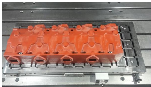
Obr. 12 Upínanie č.2 pomocou prípravku č.1.
