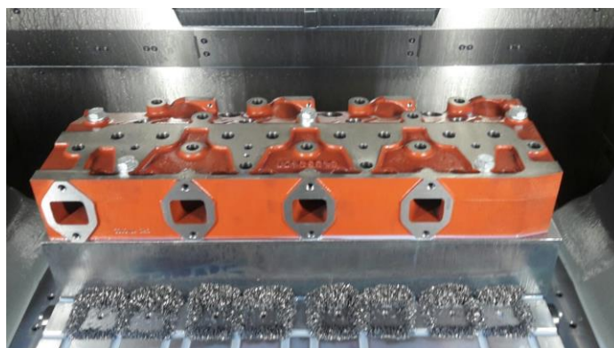
Obr. 14 Upínanie č.4 pomocou prípravku č.3.
