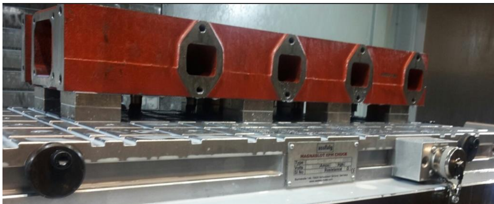
Obr. 16 Upínanie č.5 pomocou pólových nastavcov.
