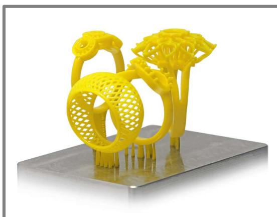
Obr. 6.3. 3D model prstenů z fotopolymerní pryskyřice plněné voskem
