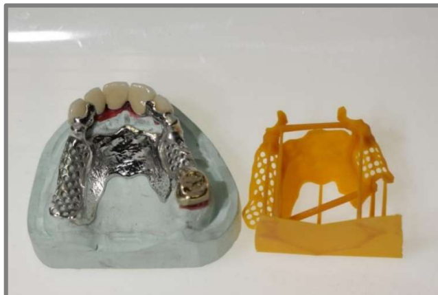
Obr. 6.2. 3D model zubní protézy z fotopolymerní pryskyřice plněné voskem
