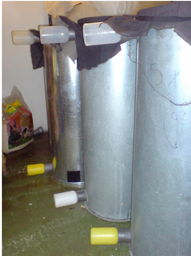
Obr. 3 Válcové fotoeklektory v klimatizovaném boxu v insektáriu.
