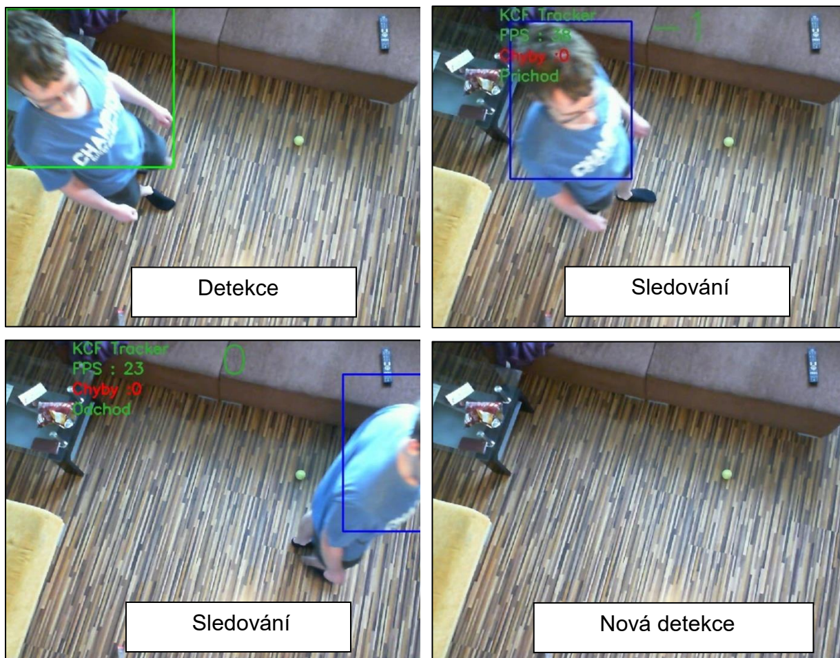
Obr. 21: Demonstrace algoritmu počítání předmětů
