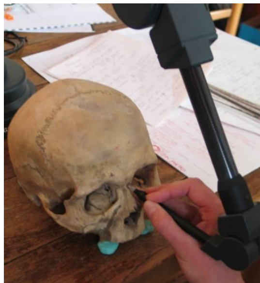
Obr. 3.10 Měření 3D souřadnice bodu pomocí MicroScribe G2X [44]
